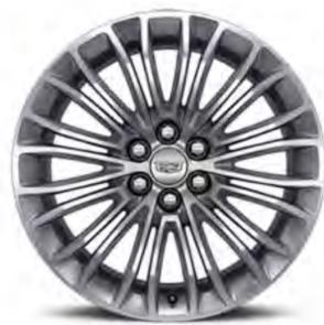
Roues de 18 po (45,7 cm) en alliage à rayons multiples au fini argent brillant
